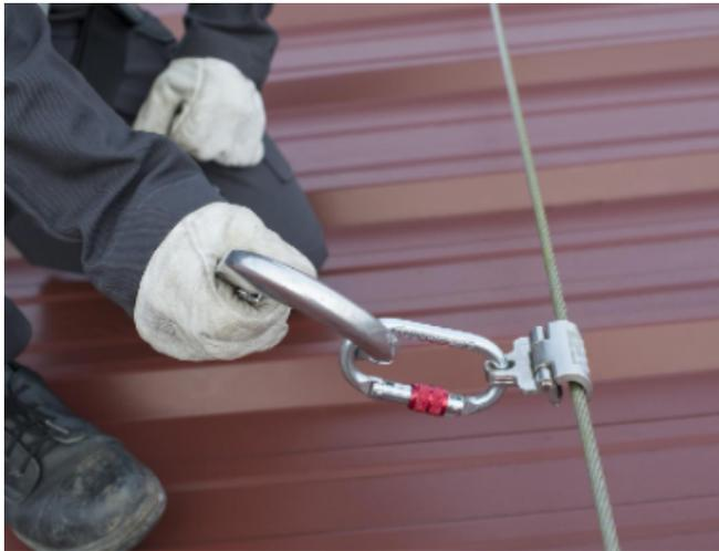
Dans le cas d'une ligne horizontale, cette pièce peut -être un mousqueton ou un coulisseau suivant le dispositif.
