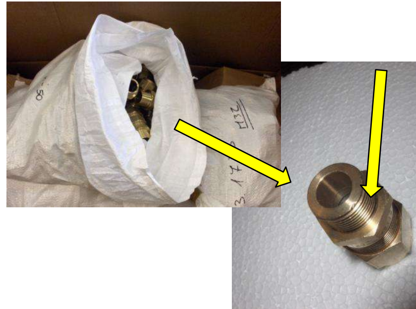
Mauvais stockage des presses étoupes, filetage abîmé « INTERDIT »
