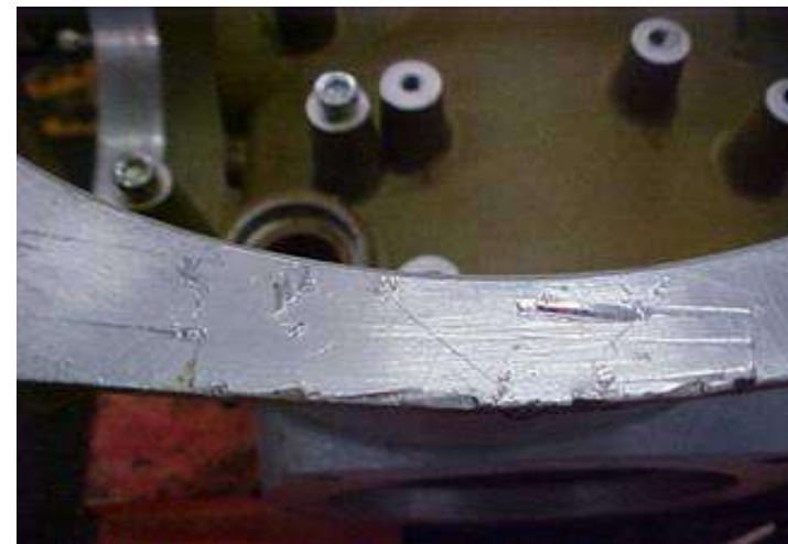
Couvercle démonté au tournevis
