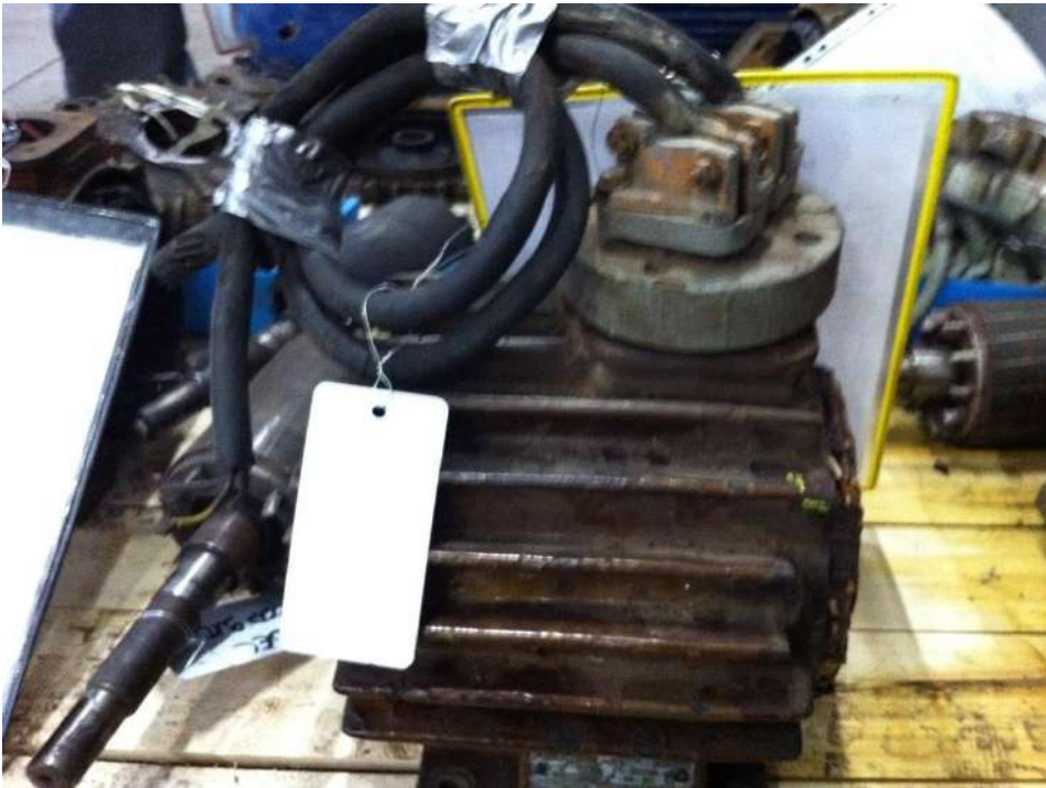
Bricolage boîte à borne moteur
