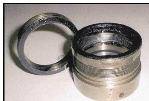
Joint du compresseur contaminé
