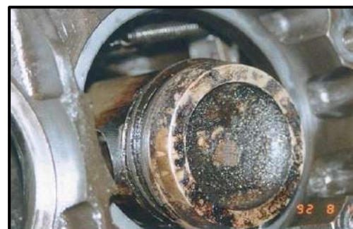
Piston de compresseur contaminé
