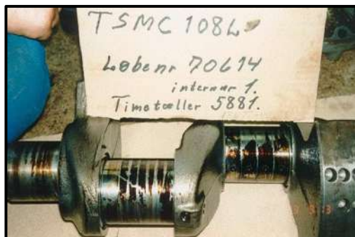
Vilebrequin de compresseur contaminé
